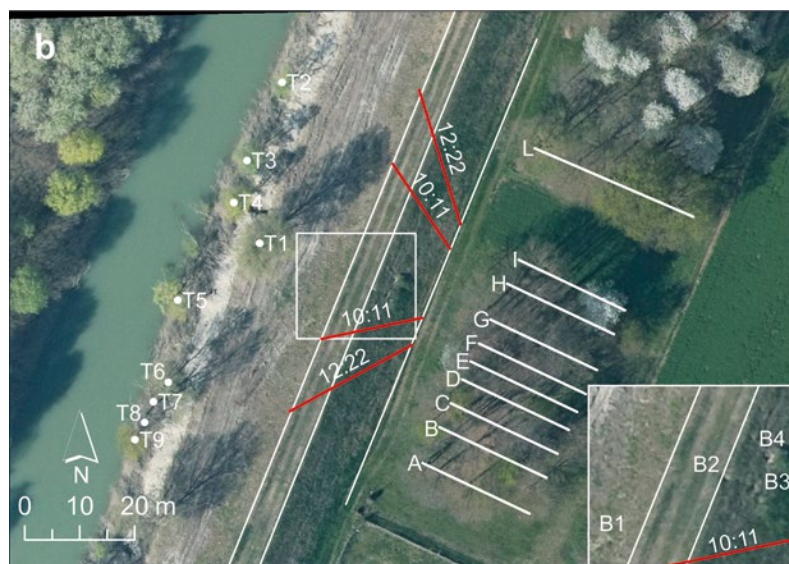
Figura 2. Identificazione delle tane nel tratto fluviale dell'argine collassato.
